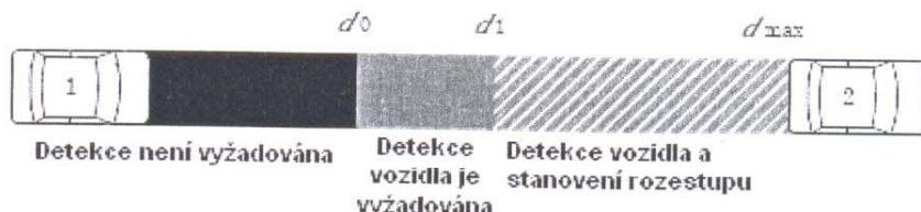
Obr. 2 Rozsah detekce (1 – předmětné vozidlo, 2 – cílové vozidlo)
