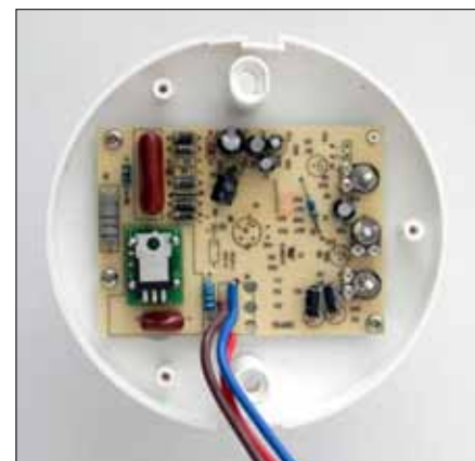
Obr. 4. Deska čidla LX28A již s nahrazeným relé
