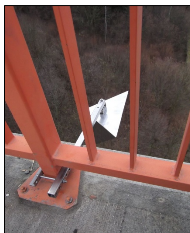
Obr. 12 – Situace při měření a koutový odražeč upevněný na zábradlí mostu
