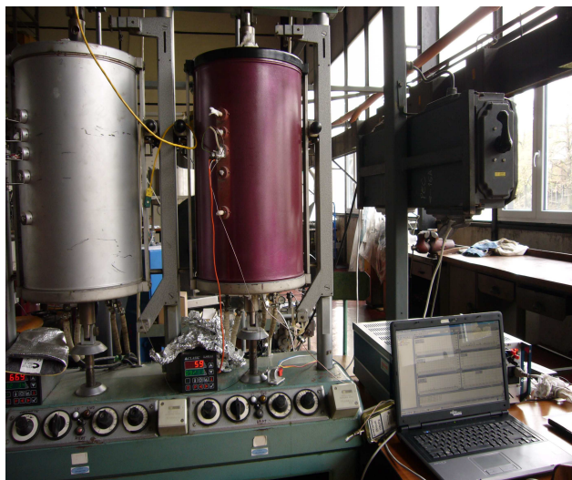
Obr. 2: Zařízení pro simulaci creepového poškození (UJP Praha).
