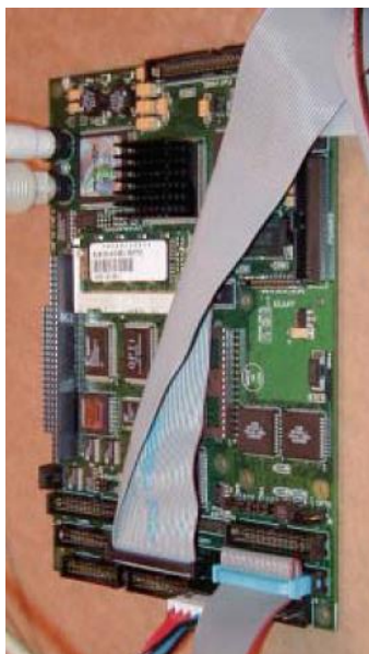
Obr. 22. Prototyp fuzzy regulátoru FUSICO (vlevo) [33], instalace FUSICO systému řízení (vpravo) [34]
