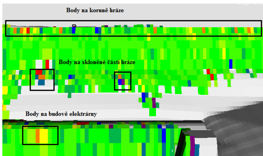
Obr. 12 - Oblasti s body podezřelými z chybně určeného pohybu
