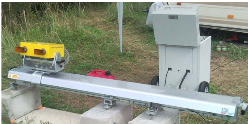
Obr. 1: Interferometický radar IBIS-L s lineárním skenerem
