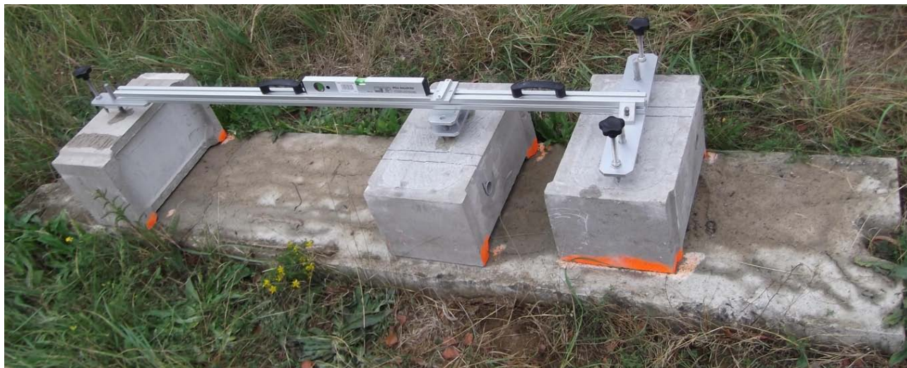
Obr. 3 - Instalační základna s kvádry
